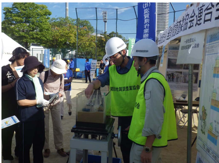
液状化現象を再現する振動台実験
